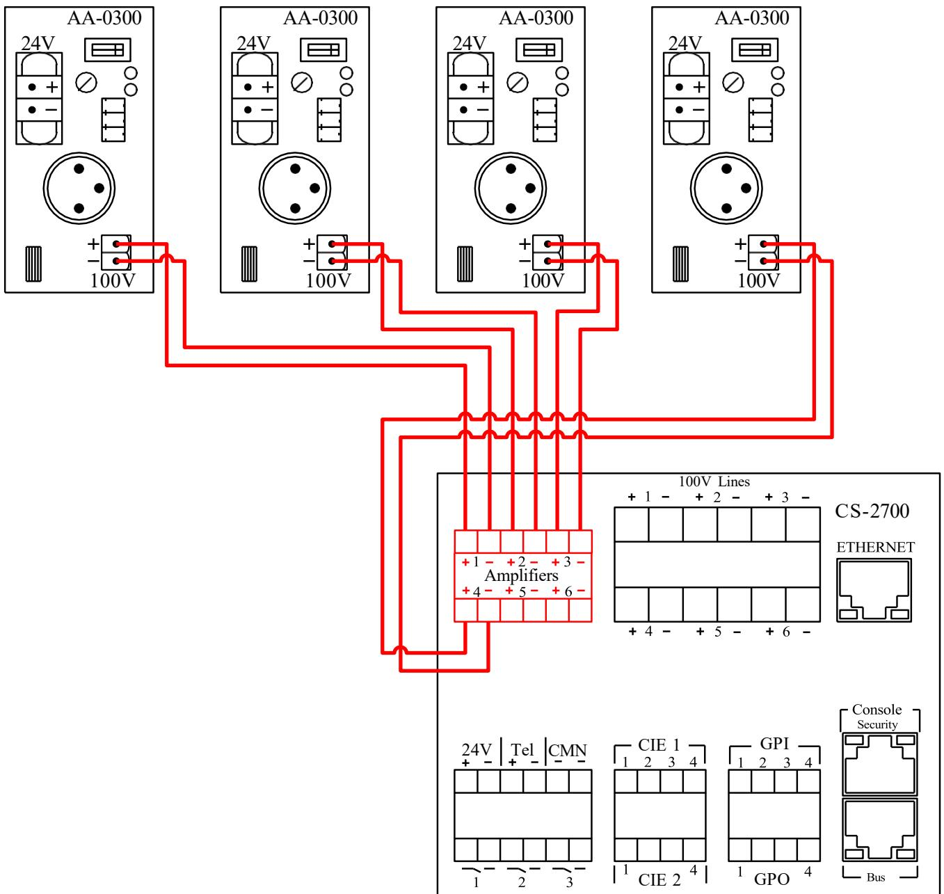
Le raccordement d'un module amplificateur de recharge (amplificateur de puissance redondants : option avec exigences) obéit au principe de câblage ci-dessus ; dans le cas où l'amplificateur de puissance redondant est présent, il est connecté sur l'entrée n°4.
