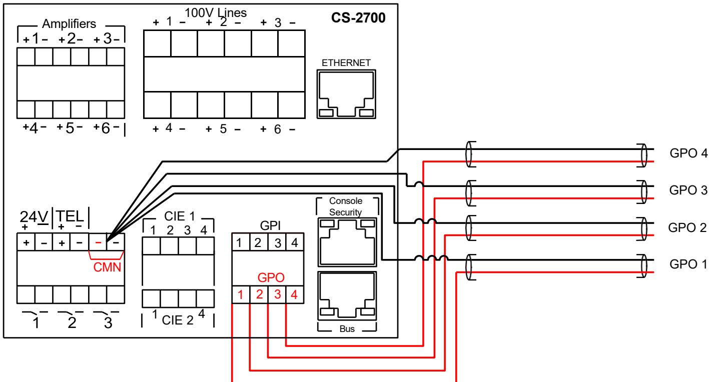
La longueur du raccordement pour le pilotage d'un périphérique externe par une GPO doit assurer une résistance ohmique de la liaison suffisamment faible pour garantir une tension de fonctionnement suffisante sur le périphérique. Le courant maximal qui peut être délivré par l'ensemble des 4 GPO doit être inférieur à 0,4A.
