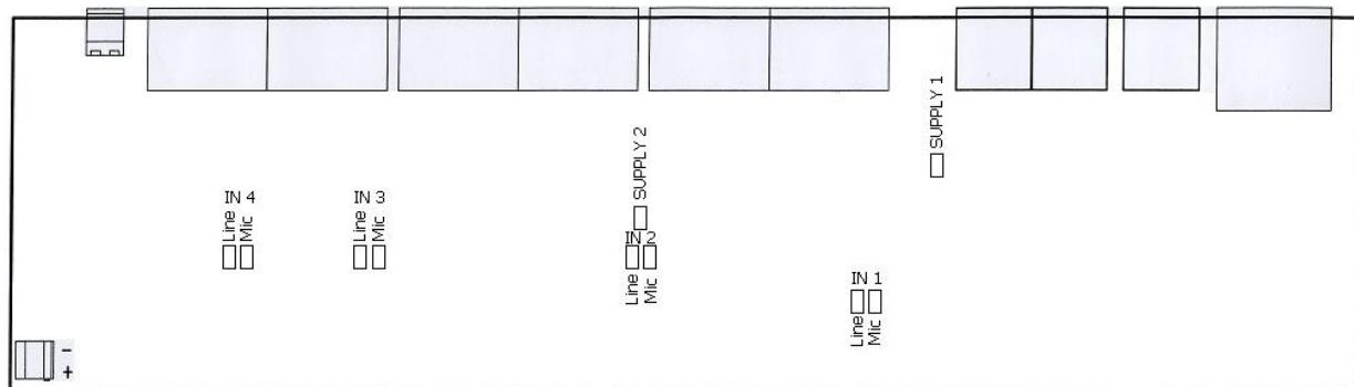
Il existe pour les entrées In1 à In4 deux configurations possibles : entrée de type Ligne (0 dBm) ou de type Micro (-52 dBm). De plus, pour les entrées audio 1 et 2 de type Micro il est possible de fournir une alimentation fantôme pour l'alimentation des microphones à électret. Pour ces différents cas, utiliser la procédure ci-dessous pour paramétriser les entrées selon votre application.
