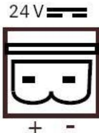
La CC 3816 peut s'alimenter aussi avec une alimentation 24 Vdc de puissance 60 W minimum à raccorder sur le bornier 2 points + 24 V.
