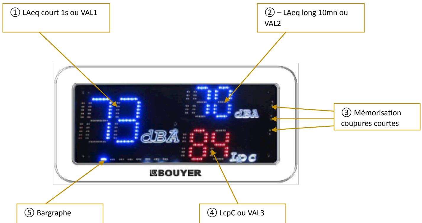
**Figure 4. L'afficheur AF-VAL1 – Vue de dessus**
