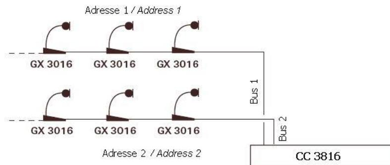
Les pupitres GX 3016 connectés sur le bus 1 doivent être paramétrés avec l'adresse 1 et les pupitres connectés sur le bus 2 doivent être paramétrés avec l'adresse 2 (voir figure ci-dessus). Pour paramétrer l'adresse des pupitres GX 3016, se reporter à la Notice du GX 3016. La connexion s'effectue à l'aide de cordon RJ 45 dont le câblage est décrit ci-dessous :
