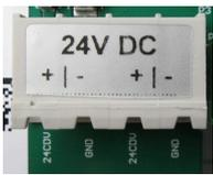
**Connecteur 1 :** Bornier d'alimentation 2 broches 24VDC « + » et 2 broches « - ».
