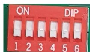
DIP Switch : Ce switch correspond à l'adresse du produit. Pour définir un identifiant sur le produit, mettre les interrupteurs souhaités en position « ON ». Veiller à ce qu'aucun autre GZ-CAPT-2 présent sur la même installation ait la même disposition des interrupteurs.
