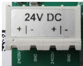
Connecteur 1 : Bornier d'alimentation 2 broches 24VDC « + » et 2 broches « - »
