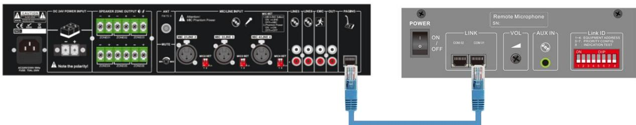
Il est possible de connecter jusqu'à 6 pupitres comme indiqué ci-dessous (distance maximale du câblage entre le 1<sup>er</sup> et le dernier pupitre = 300 mètres) :
