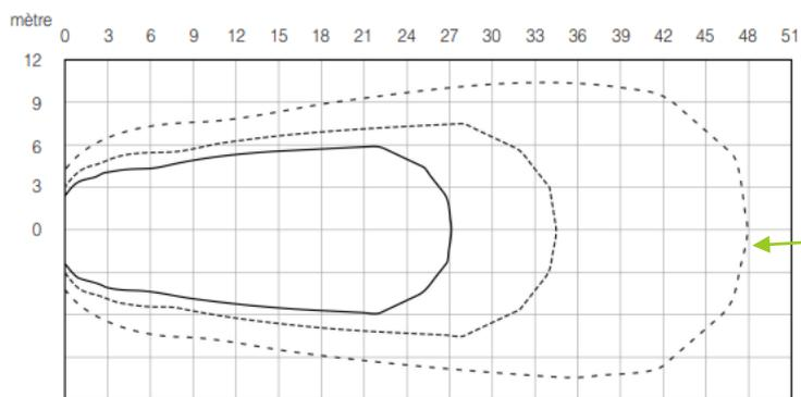
Surface couverte par le récepteur INF-RECEPT-JACK35
