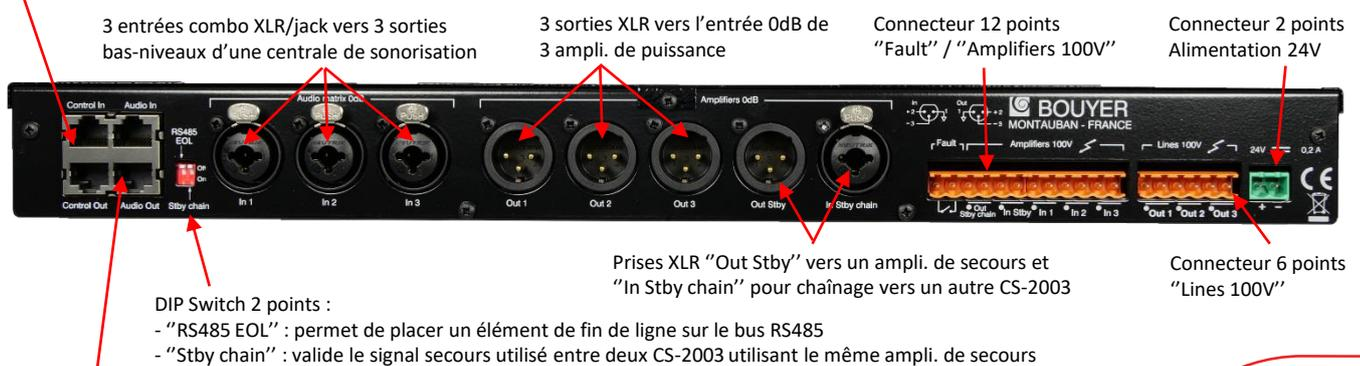
Port RJ45 "Audio In" / "Audio Out" pour connexion des entrées audios (GX-2500/1, GX-2500/2, message generator, entrée AUX)
