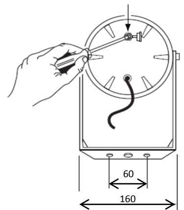
Il permet d'obtenir une grande qualité de diffusion de confort tout en assurant la sonorisation de sécurité. Son corps en ABS, conjugué à la visserie inoxydable et l'équerre en aluminium, convient particulièrement aux environnements sévères et garantit une installation durable. Le système Optiself permet de changer facilement la puissance une fois le produit installé.
