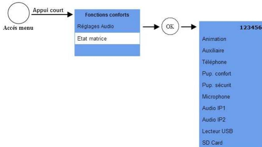
La rubrique **‘Etat Matrice’** affiche, en temps réel, l’état des commutations audios de l’ECSAV ; elle présente l’ensemble des sources audios du système et chacune des sorties 1, 2, 3, 4, 5 et 6. La présence d’une commutation en cours est symbolisée par l’apparition du symbole ‘♪’ si la source est configurée en mode Permanent ou du symbole ‘■’ pour tout autre mode. Utiliser les touches ▲ et ▼ pour faire défiler les sources audios.
