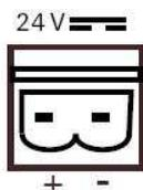
La DN 3816 peut s'alimenter aussi avec une alimentation 24 Vdc de puissance 60 W minimum à raccorder sur le bornier 2 points + 24 V.
